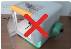
打印机正常工作时请保持舱门关闭,不要触碰喷头等部件;开始打印后请先确保模型第一层没有问题。
